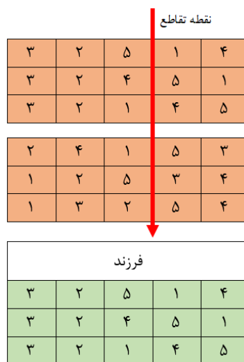
شکل (۶): چگونگی عملکرد تقاطع در NSGA-II و NPGA (چیدمان)
