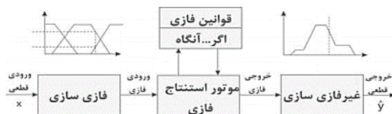
شکل ۱. ساختار کلی سیستم استنتاج فازی (صابری نصر، رضایی، دشتی و منصوری مجومرد، ۱۳۹۲)
